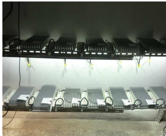
出荷前試運転テスト
